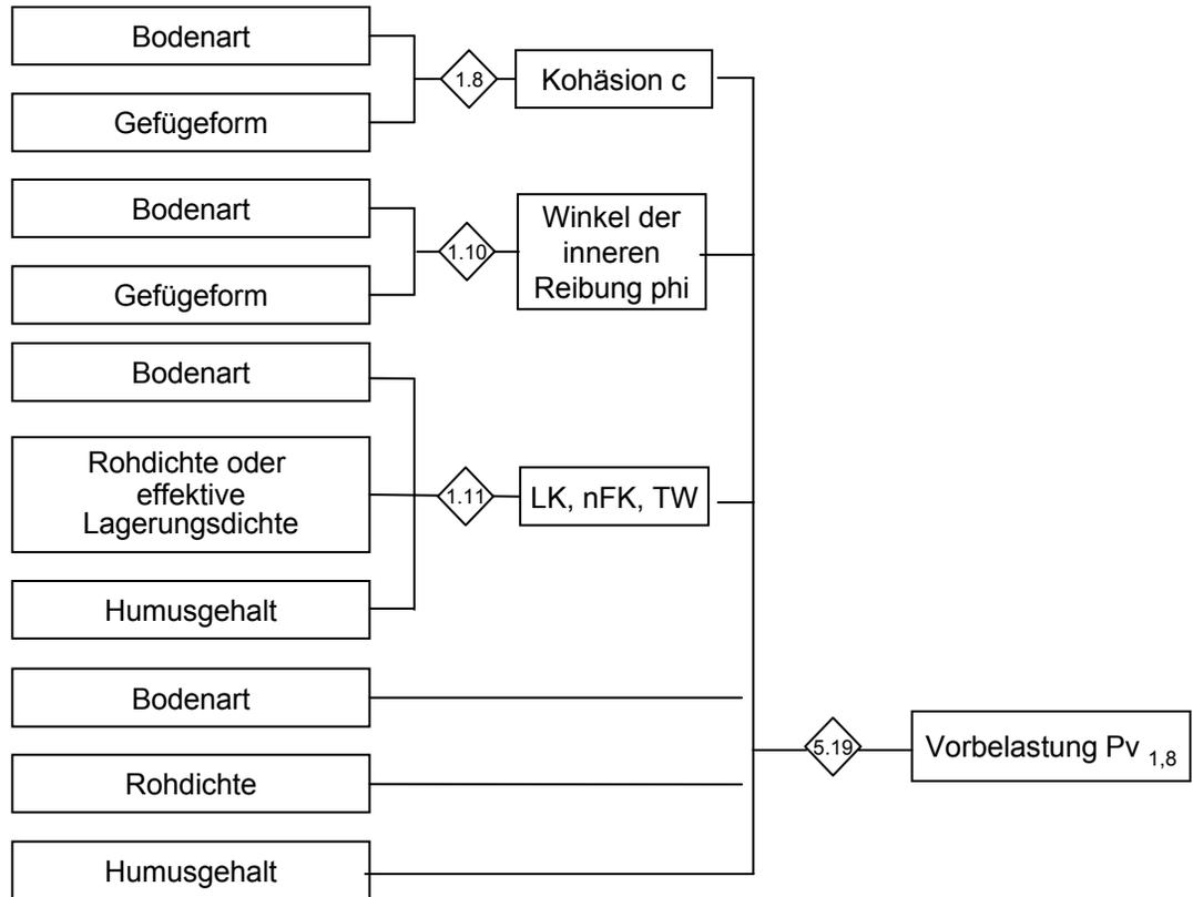
Abbildung 27: Flußplandiagramm zur Ableitung des Kennwerts "Vorbelastung bei pF 1,8 ( $P_{v1,8}$ )" nach DIN (1998) bei Verfügbarkeit detaillierter Standortinformationen
