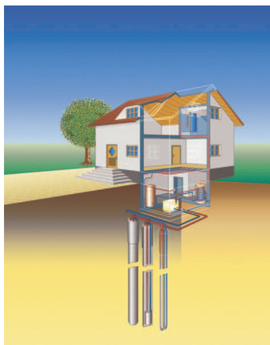
Abb. 1: Erdwärmesonde (Quelle: Bundesverband WärmePumpe e.V.).
