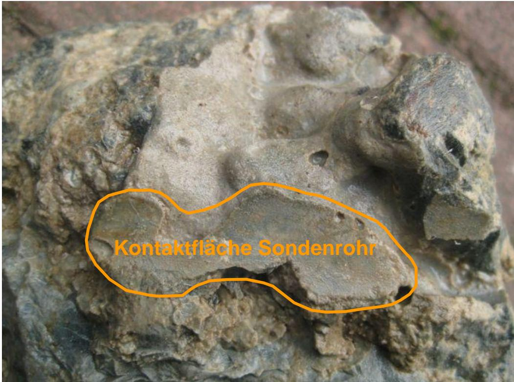
**Abb. 12:** Fehlstellen („Lunker“) in geborgener Ringraumverfüllung im direkten Kontakt zu den Sondenrohren. Foto Rumohr (2013)
